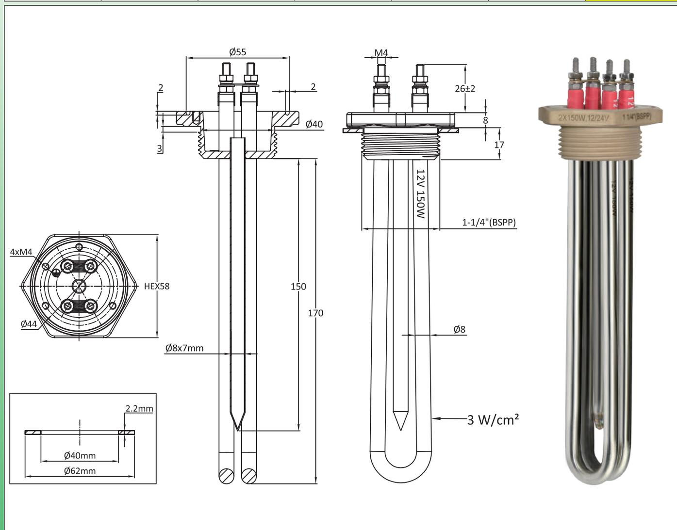
**主要用途:** 直接使用风力涡轮机或光电太阳能板产生的低电压电力，用于加热液体、家用的热水电路、热水罐。这些浸入式加热器令其可以使用产生的剩余电能，并非用于家用照明所需或小型的家用电器。它们也可用于除了家用热水罐之外的电器，限制了对配电网的电力需求。
