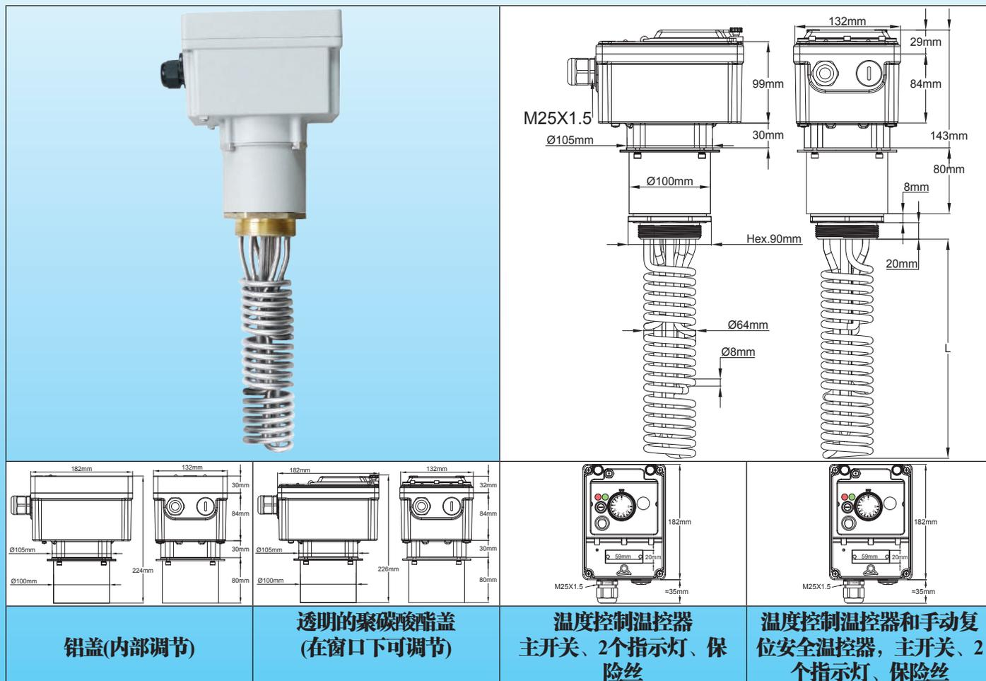
**主要用途:** 工业液体加热、热水循环、容器及缓冲罐。用于发热管浸入长度必须尽可能短的应用。这些带铝壳的加热器设计用于中等功率的三相工业应用中，其要求使用电流接触器。它们能够收纳一个功率继电器，3极32A电阻性负载。它们仅与温控器温度控制并存。外壳盖可以是透明的聚碳酸酯或铝的。它们有一个装置，在拧紧接头后允许调节外壳的位置。
