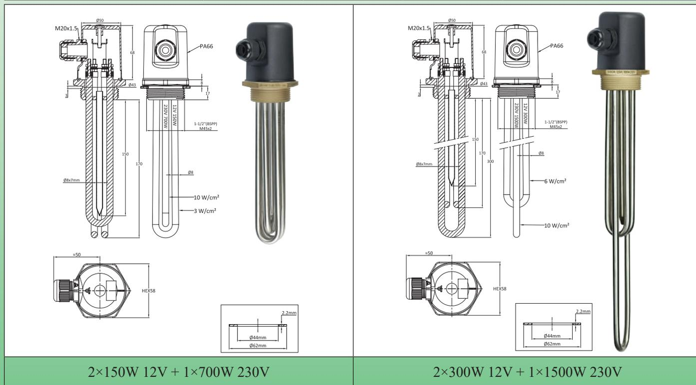
**主要应用：**直接使用风力涡轮机或光电太阳能板产生的低电压电力，用于加热液体、家用的热水电路、热水罐。这些浸入式加热器令其可以使用产生的剩余电能，并非用于家用照明所需或小型的家用电器。它们也可用于除了家用热水罐之外的电器，限制了对配电网的电力需求。
