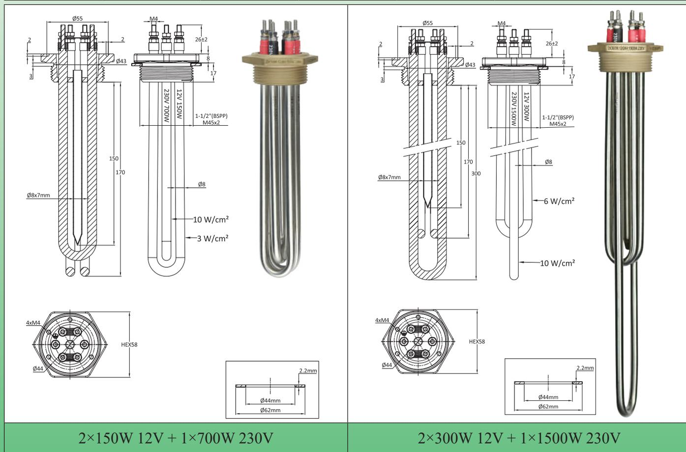
**主要用途:** 直接使用风力涡轮机或光电太阳能板产生的低电压电力，用于加热液体、家用的热水电路、热水罐。这些浸入式加热器令其可以使用产生的剩余电能，并非用于家用照明所需或小型的家用电器。它们也可用于除了家用热水罐之外的电器，限制了对配电网的电力需求。
